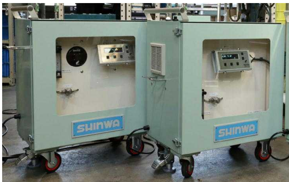
写真1 台車式鏡面冷却式露点計測システム 右：低露点仕様 左：通常露点仕様
